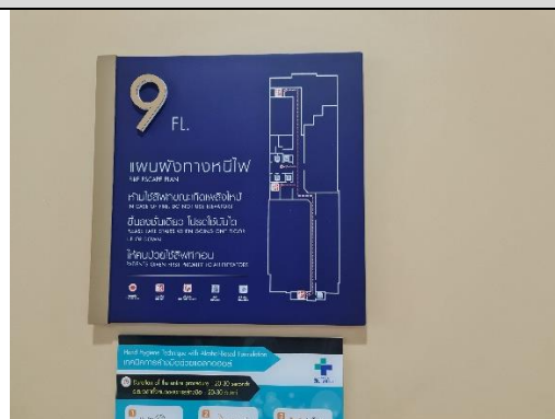
รูปที่ 2-19 ป้ายเตือนงดใช้ลิฟต์ขณะเกิดอัคคีภัย
